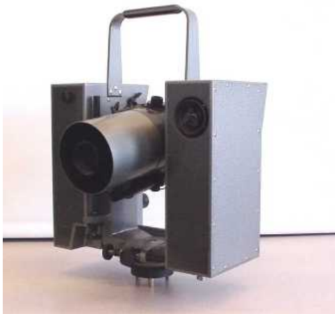
Figur 4: Den första geodimetern, modell 6, som introducerades 1964. (Alberta Land Surveyors' Association.)
