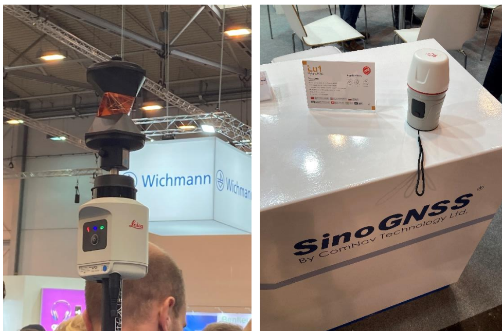
Figur 4. T.v. Leicas prismastång AP20 med tiltkompensator och automatisk stånghöjdsavläsare. T.h. SINO:s GNSS-mottagare Lu1 med integrerad laseravståndsmätare.
