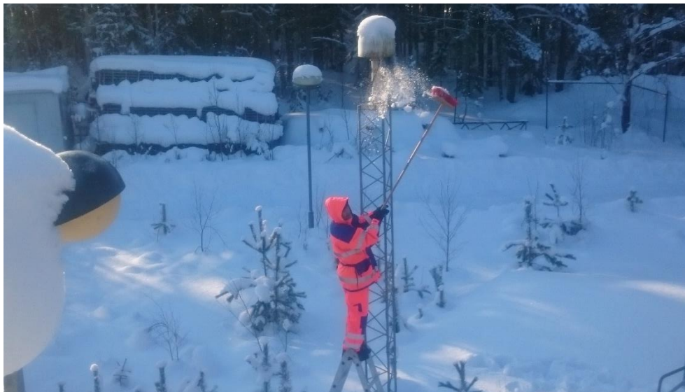
Figur 9: Bortborstning av snö från radomen på GNSS-antennen för SWEPOS-stationen Mårtsbo i samband med nätverks-RTK-testmätning i dess närhet 22 februari 2018. Bild: Kent Ohlsson.
