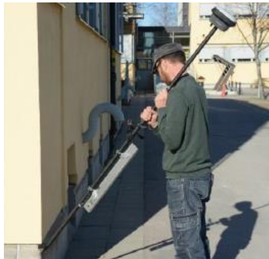
Figur 7: Fältmätningarna i examensarbetet som undersökte Leica GS18 T utfördes både i öppen och besvärlig mätmiljö samt i form av inmätning av hushörn. Bilder: Niclas Peterson och Åsa Almstedt.
