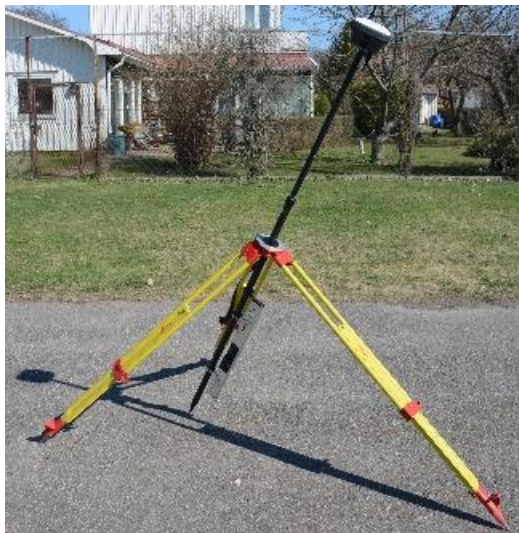
Figur 7: Fältmätningarna i examensarbetet som undersökte Leica GS18 T utfördes både i öppen och besvärlig mätmiljö samt i form av inmätning av hushörn. Bilder: Niclas Peterson och Åsa Almstedt.
