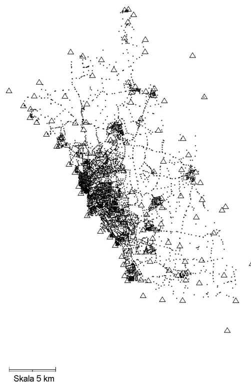
Figur 1. Samtliga punkter i Helsingborgs kommun som använts vid transformationerna. Passpunkterna är markerade med trianglar och stompunkterna med punkter. I det mönster som stompunkterna bildar kan Helsingborgs tätort, en större del av vägnätet samt den skarpa gräns som i verkligheten är kustlinjen mot Öresund, urskiljas tydligt.
