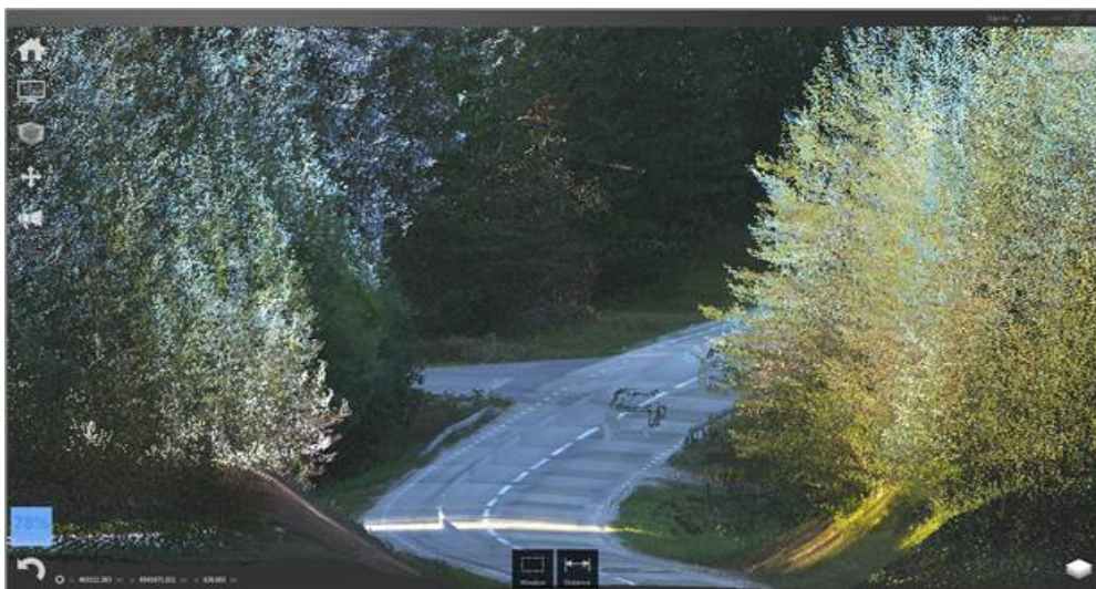
Figur 2.3.5. Exempel på punktmoln motsvarande standardnivå 3, färgsatt med RGB-värde från bilder.
