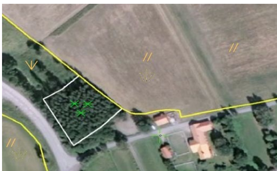
Figur D.2.5c. Exempel på marklinjer som avgränsar skogsmark, åkermark och ängsmark. Kartbeteckningarna/symbolerna kommer från Referens [5] och avser barrskog (grön symbol) samt ängsmark respektive åkermark (gulbruna symboler).
