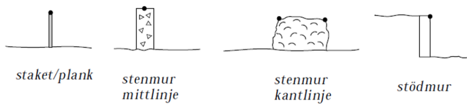
Figur D.2.3. Exempel på registrering av olika typer av hägnader.
