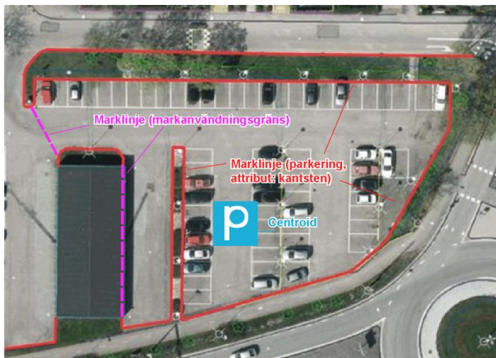
Figur D.2.5d. Exempel på parkering beskriven med naturliga kantlinjer (kantstöd/kantsten) och tätninglinjer (markanvändningsgräns) i syfte att möjliggöra ytbildning. En centroid bär koden för markanvändningen (parkering).
